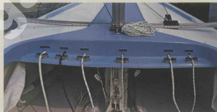
Consolle frontale per manovre spinnaker, strallo prua, terzaroli, girafiocco e colonnetta per i vari rimandi, drizze randa e fiocco.
