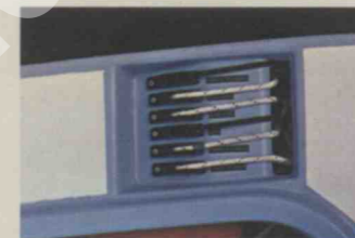
Ai lati del pozzetto le manovre carrello fiocco, carrello randa, vang, cunningham, tela boma e strallo poppa.
